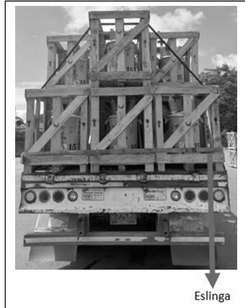
Figura 19: Aseguramiento última fila transformadores cargados
