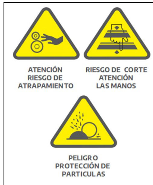
Figura 2: Señales de riesgo mecánico
