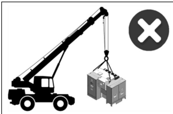
Figura 9: Prohibido transportar el transformador de las orejas de levante
