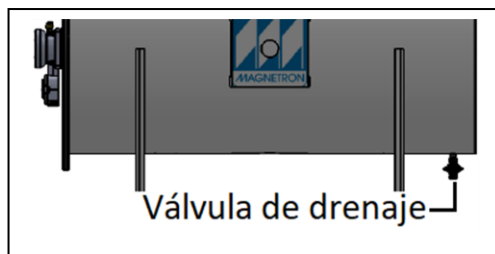
Figura 43: Válvula drenaje tanque conservador (de expansión)
