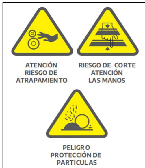
Figura 2: Señales de riesgo mecánico
