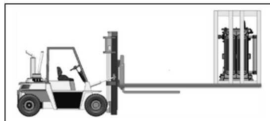
Figura 45: Forma adecuada de jalar un transformador en el descargue.
