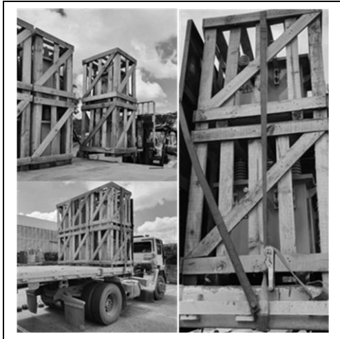
Figura 21: Cargue y aseguramiento de la primera fila
