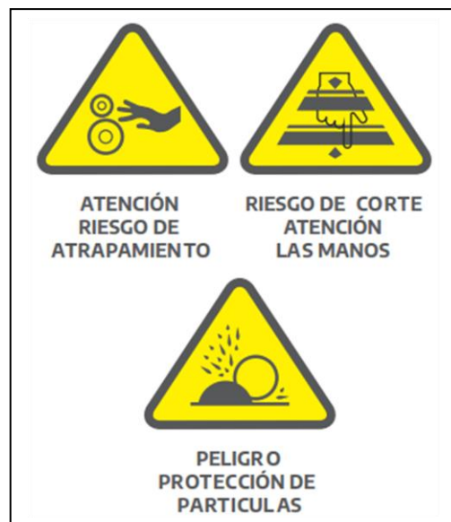
Figura 2: Señales de riesgo mecánico
