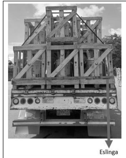
Figura 23: Aseguramiento última fila transformadores cargados
