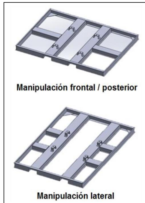
Figura 13: Base metálica para transformadores de potencia
