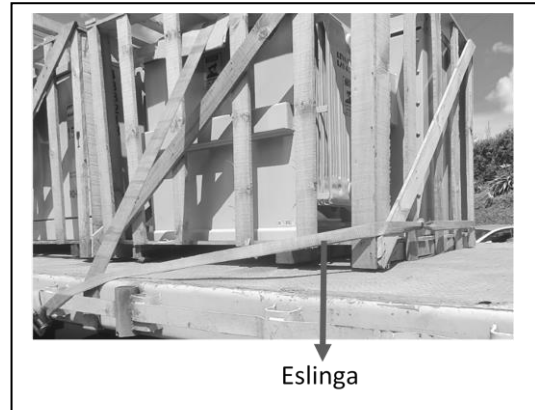
Figura 30: Aseguramiento última fila transformadores cargados
