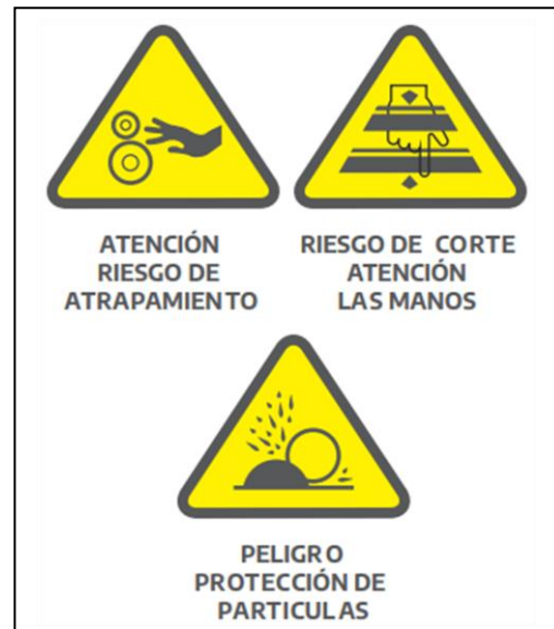
Figura 2: Señales de riesgo mecánico
