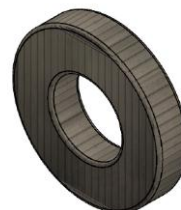
Figura 11. Transformador de corriente.
