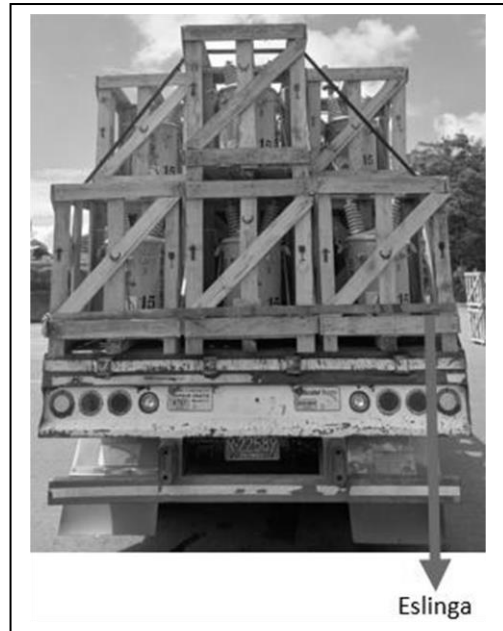
Figura 19: Aseguramiento última fila transformadores cargados
