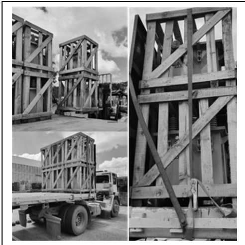
Figura 17: Carga y aseguramiento de la primera fila
