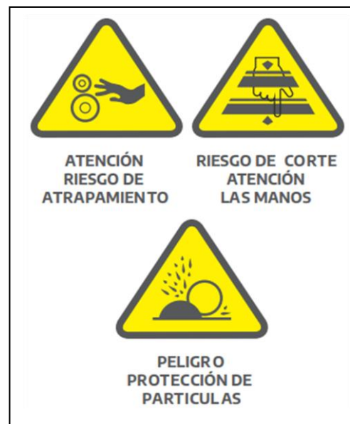
Figura 2: Señales de riesgo mecánico
