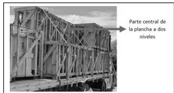
Figura 20: Dos niveles en la parte central de la plancha, nivelación carga.
