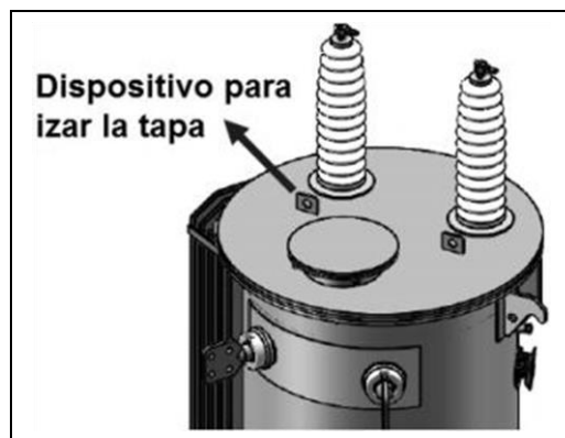
Figura 38: Dispositivos para izaje de la tapa
