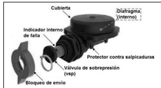
Figura 41: Partes del IFD
