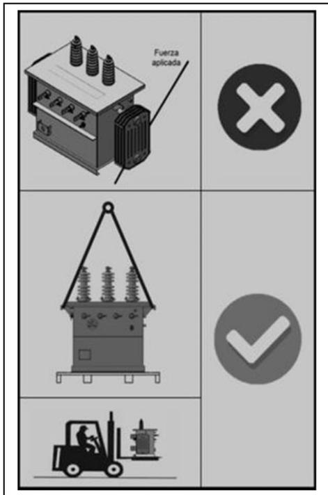
Figura 5: Manipulación transformador.
