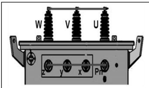
Figura 49: Cortocircuito terminales de media y baja tensión
