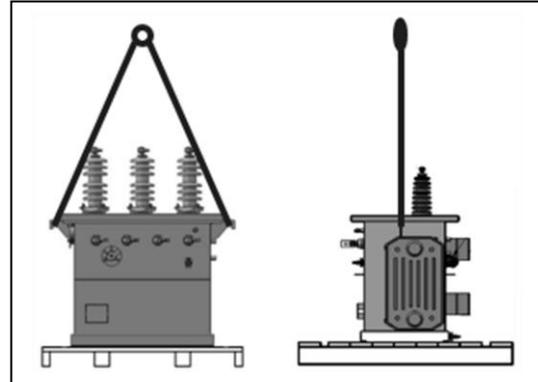
Figura 12: Elevación transformador desde las orejas de levante
