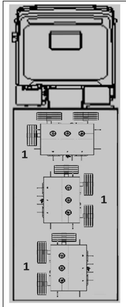
Figura 15: Radiadores intercalados para balancear la carga
