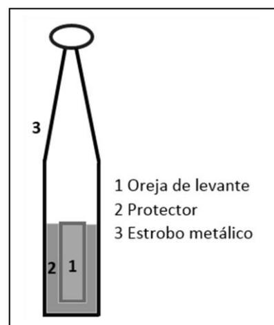
Figura 7: Protección pintura en las orejas de levante
