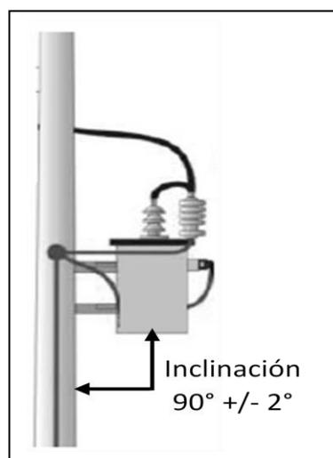
Figura 50: Grado de inclinación
