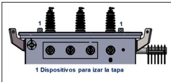
Figura 44: Dispositivos para izaje de la tapa
