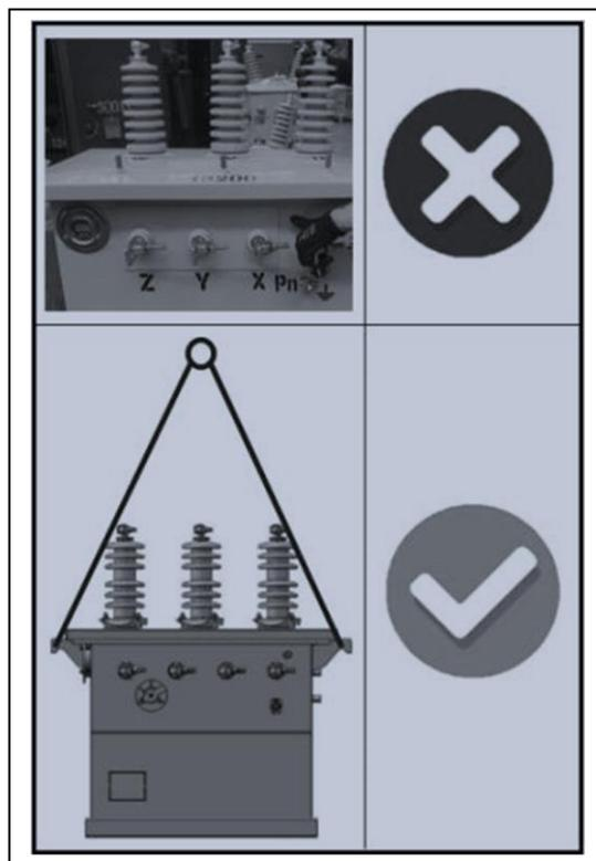
Figura 4: Manipulación transformadores
