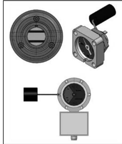
Figura 37: Indicadores del nivel del líquido aislante
