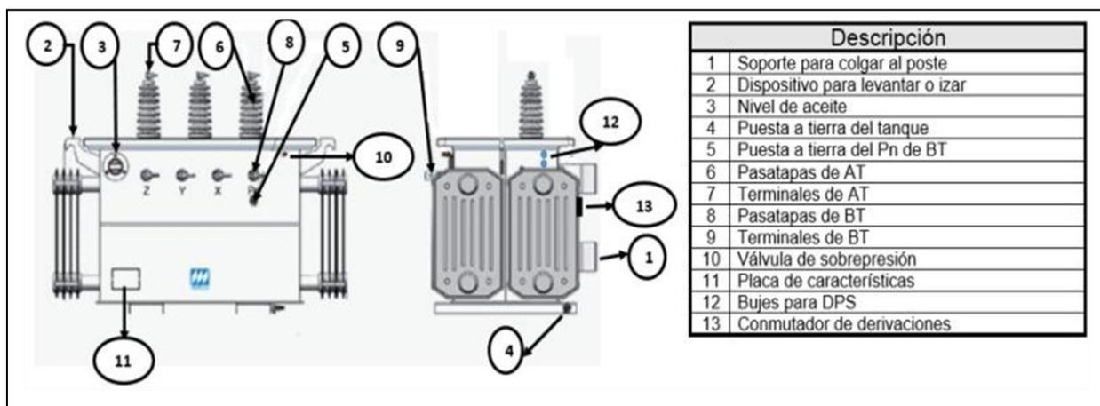
Figura 52: Partes externas del transformador
