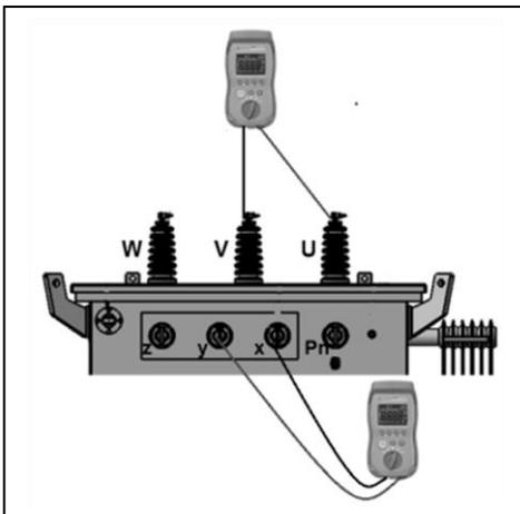
Figura 48: Medición continuidad en media y baja tensión
