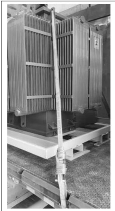
Figura 16: Ejemplo para asegurar el producto con eslingas
