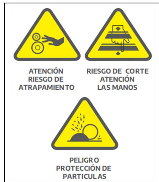
Figura 2: Señales de riesgo mecánico
