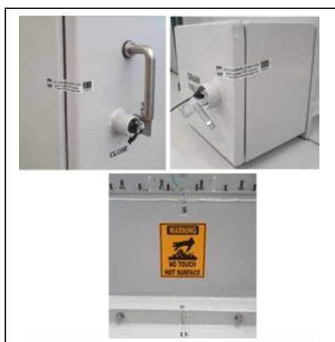
Figura 29: Sello de seguridad en partes removibles
