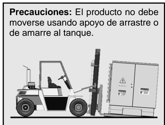
Figura 27: Forma adecuada de jalar el producto en el descargue.
