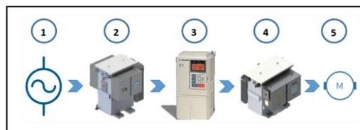
1. Fuente de energía eléctrica: Generador 480V – Red Eléctrica 480 – 13200 – 13800V
