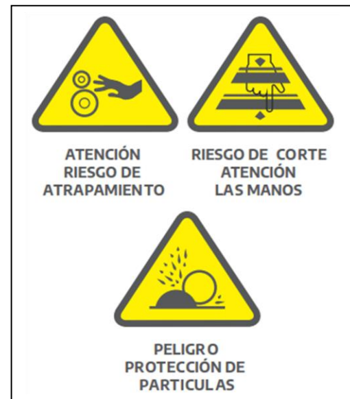
Figura 2: Señales de riesgo mecánico
