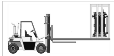
Figura 28: Forma adecuada de jalar un transformador en el descargue.
