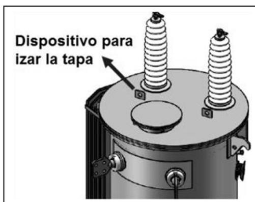
Figura 38: Dispositivos para izaje de la tapa
