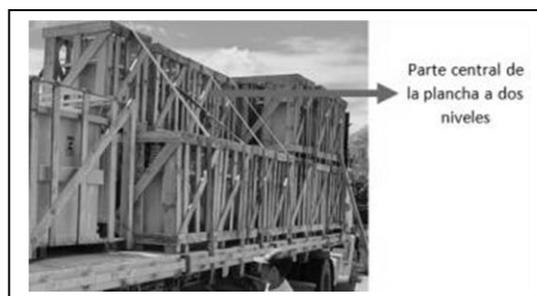
Figura 20: Dos niveles en la parte central de la plancha, nivelación carga.
