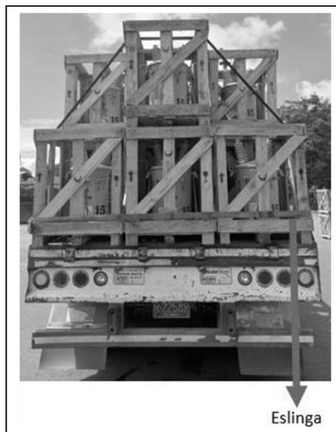
Figura 19: Aseguramiento última fila transformadores cargados
