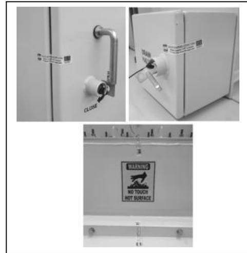
Figura 34: Sello de seguridad en partes removibles
