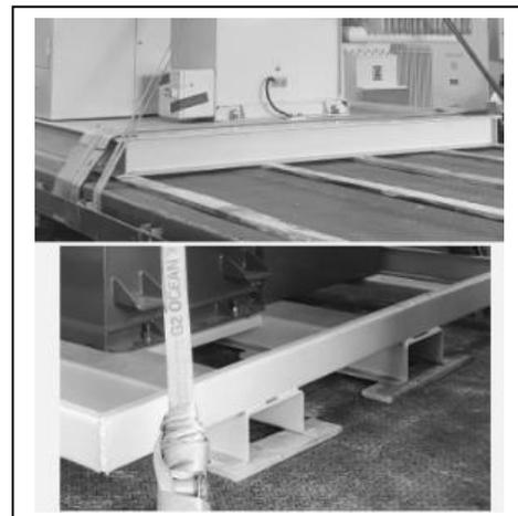
Figura 22: Tablas de madera entre la base metálica del transformador y el piso metálico del camión
