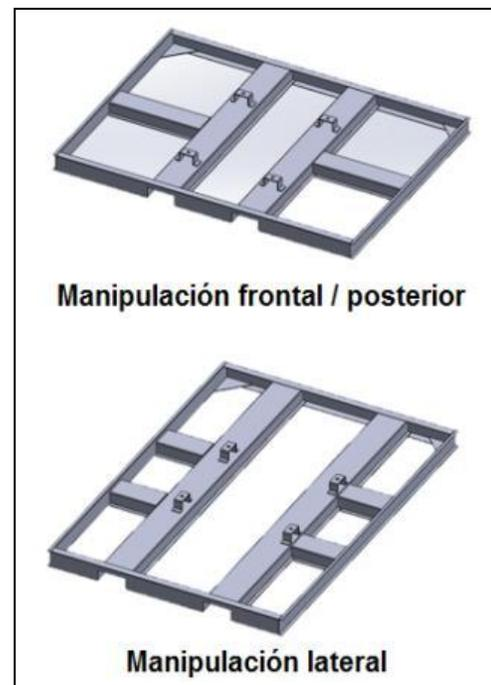
Figura 13: Base metálica para transformadores de potencia
